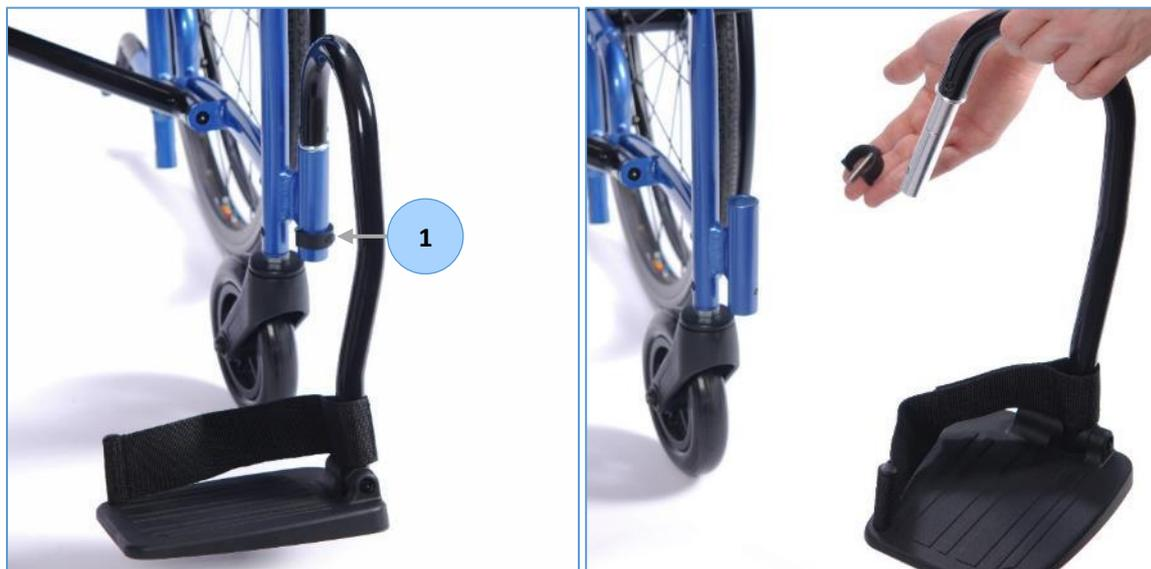
Die Fußstützen können vollständig abgenommen werden. Hierzu muss die schwarze Kunststoffschelle mit dem Arretierstift (1) horizontal aus dem Rohr gezogen werden. Anschließend kann die gesamte Fußstütze aus der Führung gezogen werden. Beim Einsetzen ist darauf zu achten, dass sich das Loch für den Arretierstift in der Fußstütze und das Loch im Rahmenrohr hintereinander befinden.
