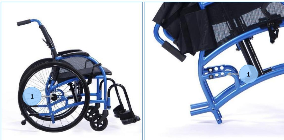
Je weiter hinten die Achsaufnahme installiert ist, desto kippstabiler ist der Rollstuhl in der Benutzung, d.h. ein unbeabsichtigtes Kippen nach hinten ist in dieser Konfiguration am unwahrscheinlichsten. Je weiter vorne die Achsaufnahme installiert wird, desto weniger anteiliges Gewicht lastet auf den Lenkrollen vorne und desto einfacher ist ein beabsichtigtes Kippen des Rollstuhls nach hinten (durch den Benutzer oder die Begleitperson), wodurch der Rollstuhl einfacher zu Manövrieren ist.
