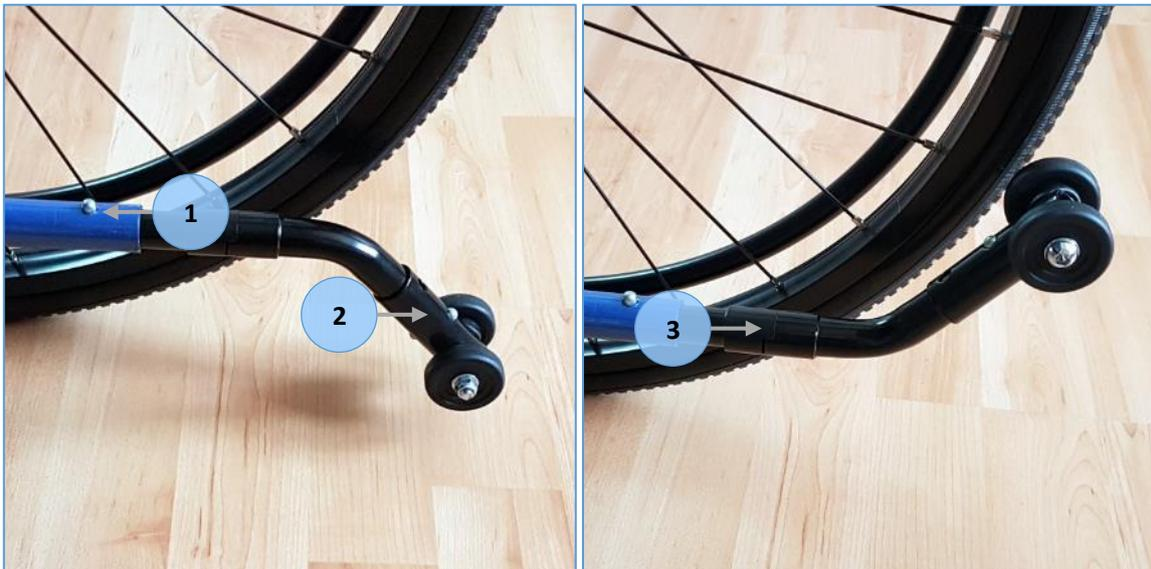
Um eine hohe Stufe (z.B. Bordstein) herauf- oder herunterzufahren, müssen die Kippschutzräder nach oben geschwenkt werden, um ein Aufsetzen zu vermeiden. Sie können durch Ziehen nach hinten entriegelt (2) und nach oben/unten geschwenkt werden.
