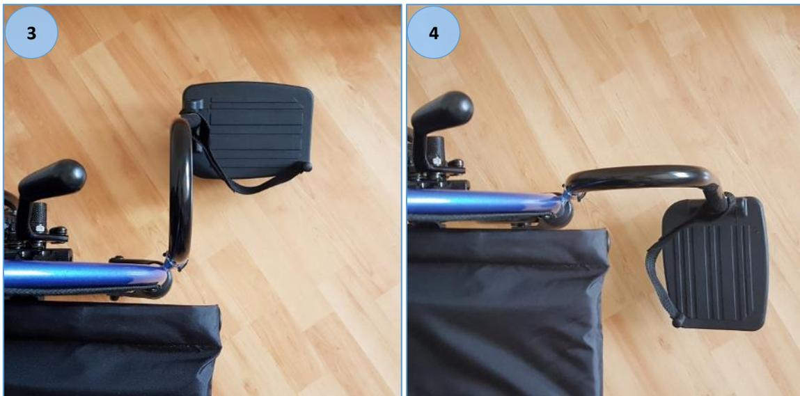
Die seitliche Einrastposition ist nur zur Verwendung zum Ein- und Aussteigen gedacht. Mit in dieser Position eingerasteten Fußstützen den Rollstuhl nicht fahren, um zu verhindern, an einem Hindernis hängenzubleiben.
