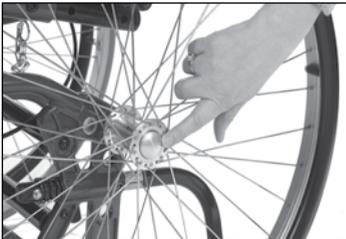
**⚠** Um zu kontrollieren, ob das Antriebsrad korrekt eingerastet ist, lassen Sie den Entriegelungsknopf los und ziehen das Antriebsrad leicht nach außen.
