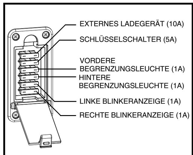
Abb. 7. Lenkerkonsolen Sicherungen
