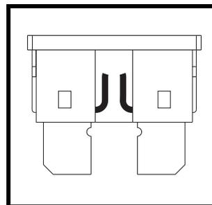
Abb. 24A. Durchgebrannte Sicherung (auswechseln)
