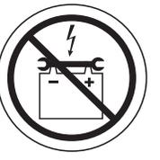
**Halten Sie Werkzeuge oder andere Metallobjekte von den Batterieanschlüssen fern. Der Kontakt mit Werkzeugen kann einen elektrischen Schlag auslösen.**
