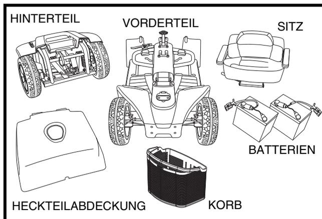
Abb. 20. Elektromobil Komponenten
