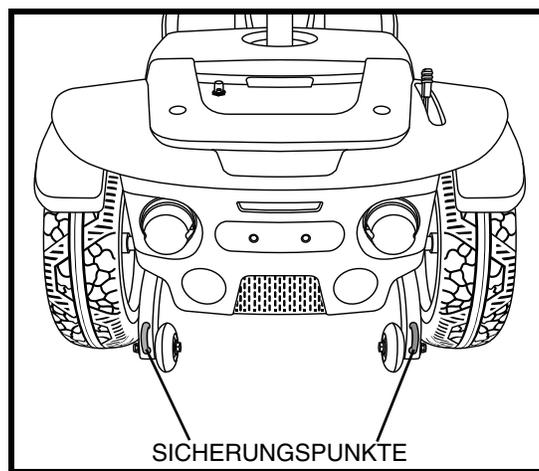
Abb. 9A. Hintere Sicherungspunkte
