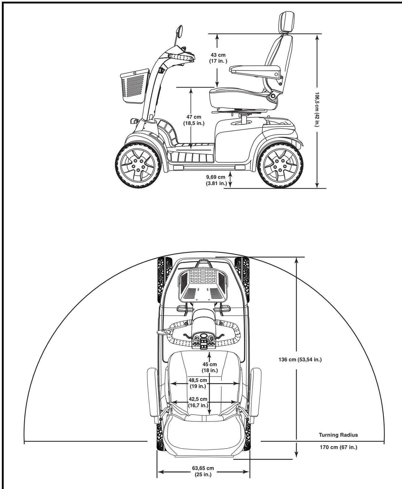
Abb. 25. Elektromobil Abmessungen
