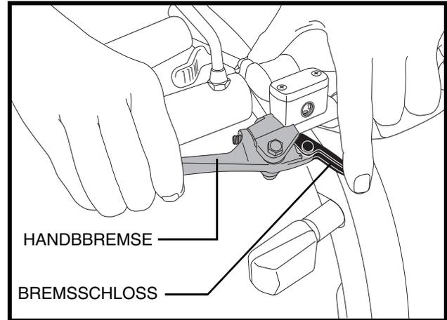
Abb. 5. Handbremse und Bremsschloss (im geschlossenen Zustand)
