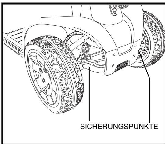
Abb. 9. Vordere Sicherungspunkte
