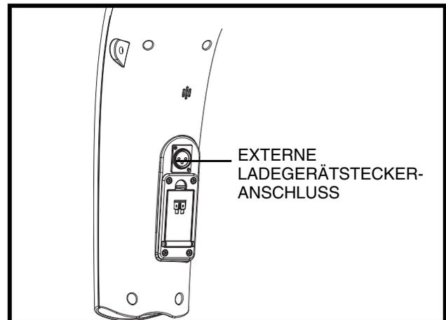
Abb. 6. Steckdose für Ladegerätkabel (auf dem Lenker)
