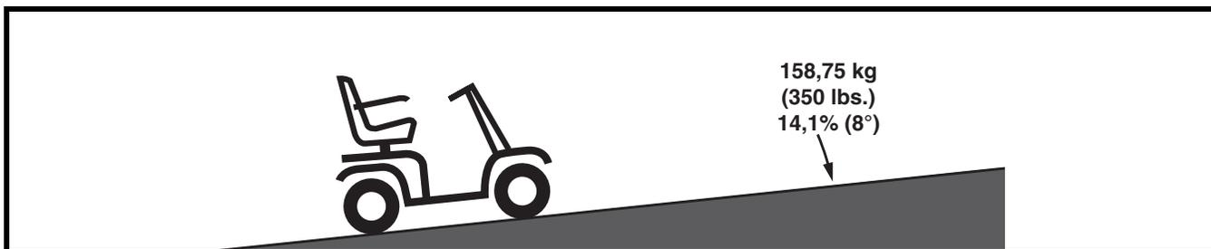
Abb. 1. Maximal Empfohlene Steigung für 4-Rad Betrieb
