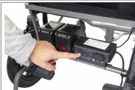
Hier schalten Sie die Hauptstromversorgung ein, die den Handset-Controller mit Strom versorgt.
