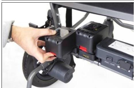
Batterien können entfernt werden, indem die rote Lasche nach oben gedrückt und nach hinten gezogen wird.
