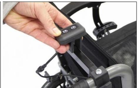
**7** ...Steuerstab in den Armlehnenbeschlag unter der Armlehne einführen...
