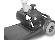
Griff des Batterie-Packs festhalten, mit dem Daumen an Hebel <sup>Ⓐ</sup> am Batterie-Pack ziehen und das Batterie-Pack entfernen.
